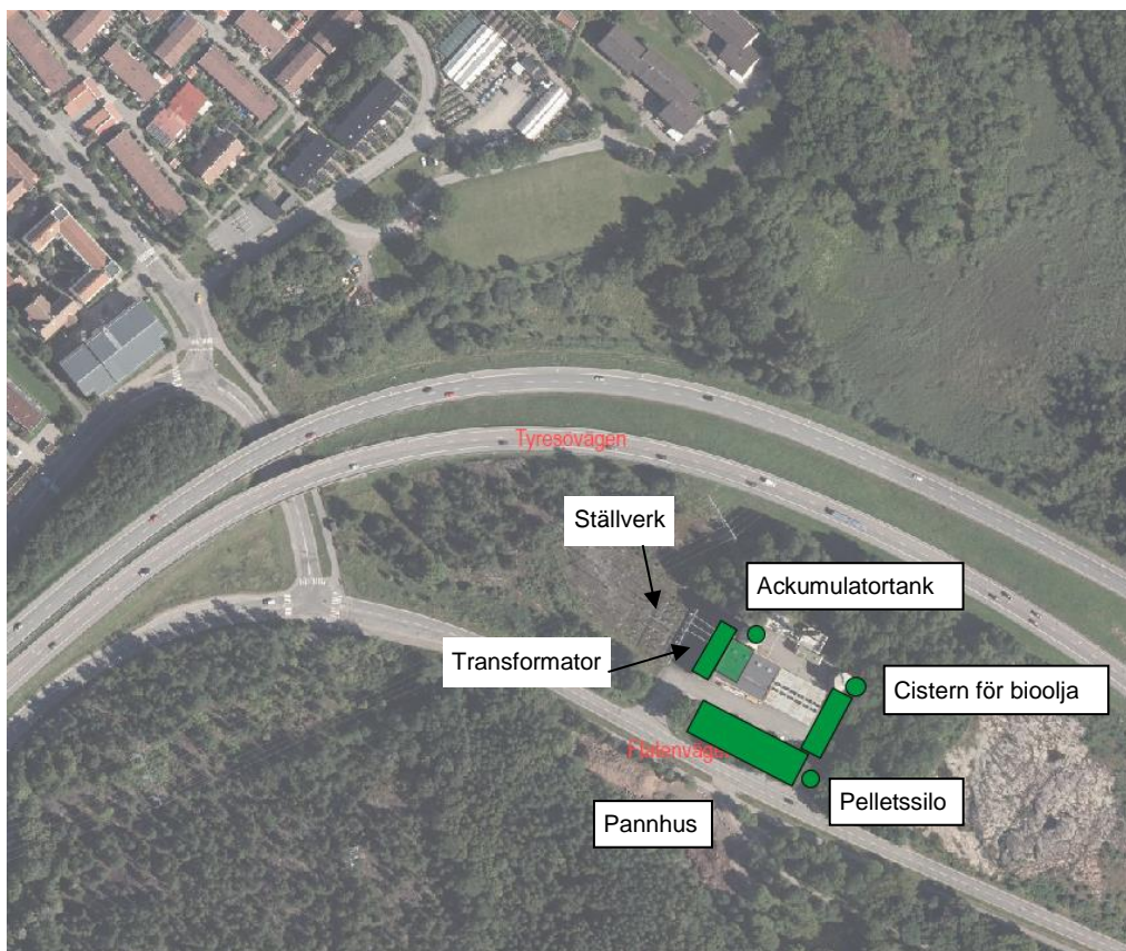
Figur 8. Verksamhet efter förändring (gröna rutor) och en möjlig placering av anläggningens delar. Transformator och ackumulatortank behålls från nuvarande anläggning. Ställverket ingår inte i aktuell verksamhet men kommer också att behållas.
