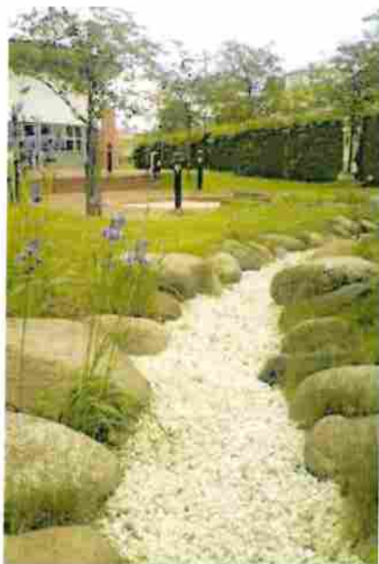
Figur 14 Exempel på stråk för fördröjning av dagvatten i form av grusbädd med omgivande gräs (Stockholm stad 2013).
