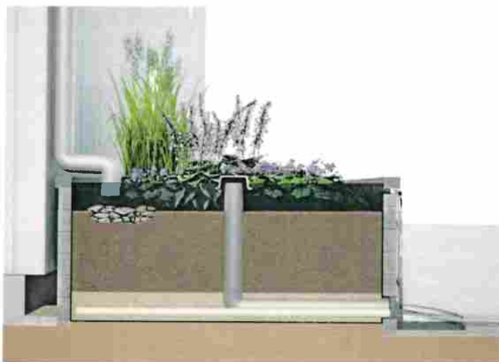
Figur 13 Växtbädd med tät duk för takvatten (Fridell, K och Klasson, K, Tengbomgruppen AB, 2014)
